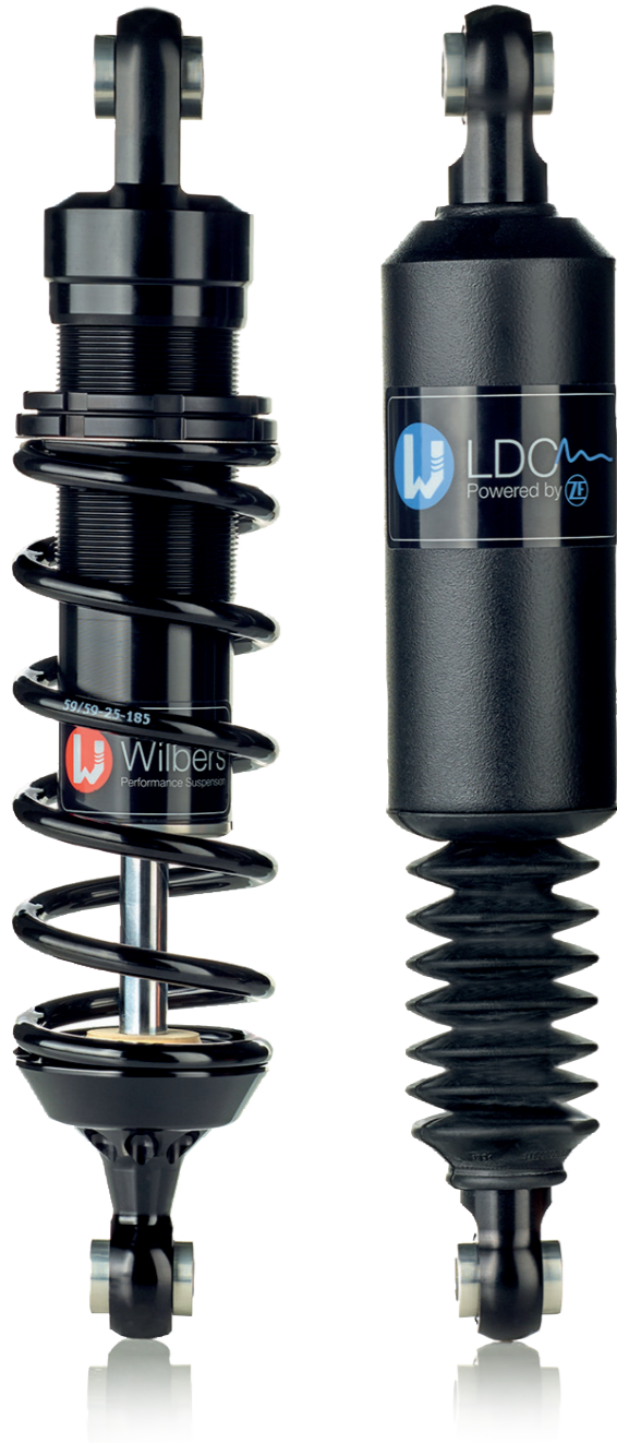
Twin Shock: Hinten wird ein Ecoline Federbein auf der einen Seite und der Nivomat auf der anderen Seite verbaut. Twin Shock: Rear is an Ecoline shock on one side and the Nivomat on the other.
